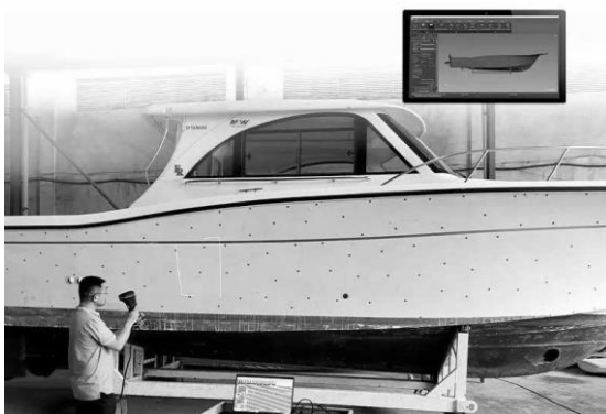
Фиг. 6. Инспекция формата и размерите чрез 3D сканиране.
